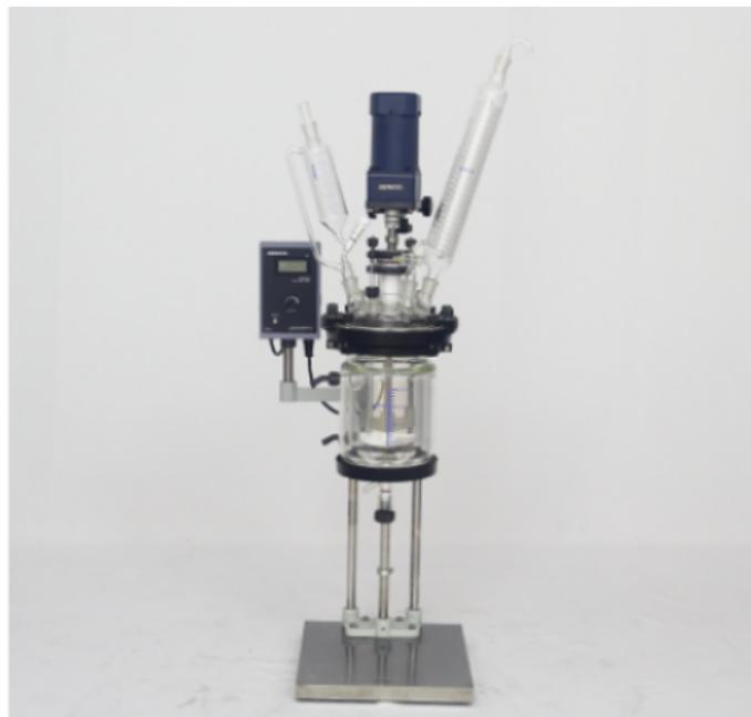
夹套玻璃反应釜通常称为夹套玻璃反应器，中间层用来防止反应溶剂进行搅拌反应，中间层可以通过冷源和热源进行恒温加热或冷却反应。与单层玻璃电抗器相比，夹套玻璃电抗器具有许多优点。从双层夹套玻璃电抗器的出现可以直接观察整个实验过程，但单层玻璃电抗器不太方便。
