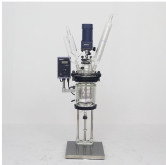
开盖式夹套玻璃反应釜内层溶器放置反应物料，同时可抽真空和调速搅拌，使反应物料减压条件下，进行汽化和蒸发，对物料进行浓缩和提纯。双层玻璃反应釜广泛应用于化学、精细化工、生物制药新材料合成等实验、中试及生产。
