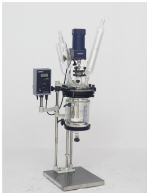
夹套玻璃反应釜的安全设置夹套玻璃反应釜的反应量较大，使用过程中周围空气中的溶剂浓度较大，因此，必须进行安全设置。对于夹套玻璃反应釜防爆设计主要在搅拌用的电机以及电源控制器设置为防爆电机，防爆开关以及防爆电源控制器。一般厂家均可以提供安装，费用稍贵，但是为了安全还是值得的。由于反应的溶剂量较大，周围空气易出现高浓度，因此，工作场所有必要安装气体报警器。反应釜周围不要堆放溶剂或者杂物，预留安全通道畅通FC202夹套玻璃反应釜结构组成部分。制造FC202夹套玻璃反应釜推荐厂家
